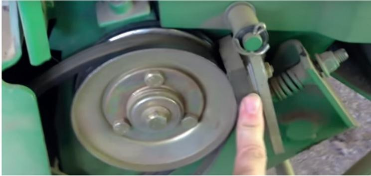
Aumente la tensión del freno con el uso de cuñas adicionales que se agregan detrás de la placa de fijación. Verifique que los rodillos de alimentación estén alineados (vea el Sistema de alimentación arriba).
