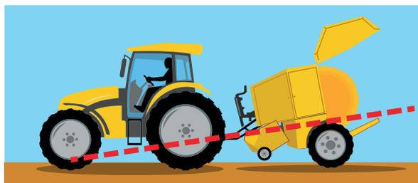
угол наклона пресс-подборщика к трактору препятствует правильному выбрасыванию тюка из камеры прессования пресс-подборщика
