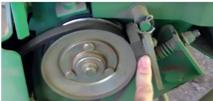
Aumentare la tensione del freno con l'uso di ulteriori spessori aggiunti dietro la piastra di fissaggio. Verificare che i rulli di alimentazione siano allineati (vedere Sistema di alimentazione sopra)
