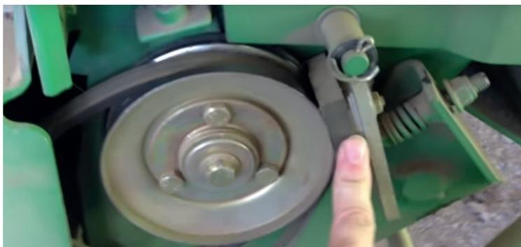
Augmentez la tension des freins en ajoutant des cales supplémentaires derrière la plaque de fixation. Vérifiez que les rouleaux d'alimentation sont alignés (voir Système d'alimentation ci-dessus).
