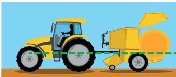
La balle peut être éjectée doucement du hayon lorsque la presse est correctement alignée au tracteur.
